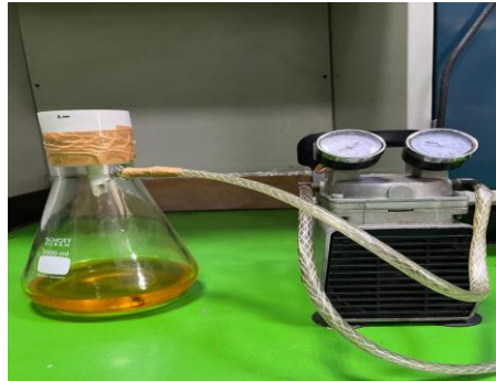
Gambar 5. Peralatan Filtrasi dan Pompa Vakum dalam Penentuan TC Biodiesel
