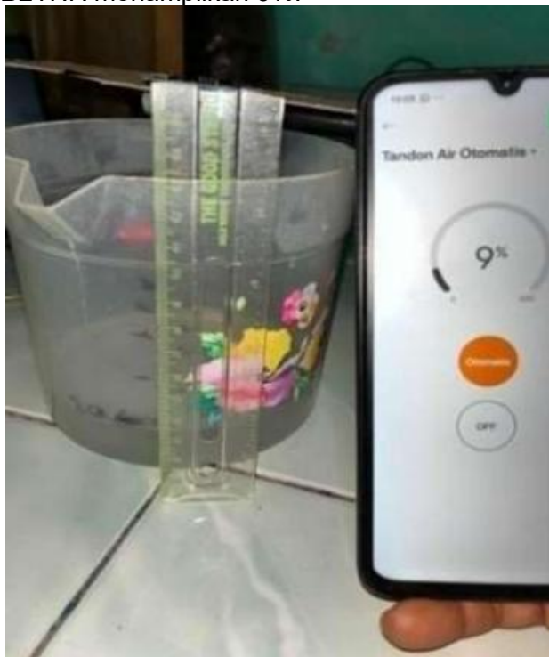
Gambar 10 Pengujian Aktual Tinggi Air
