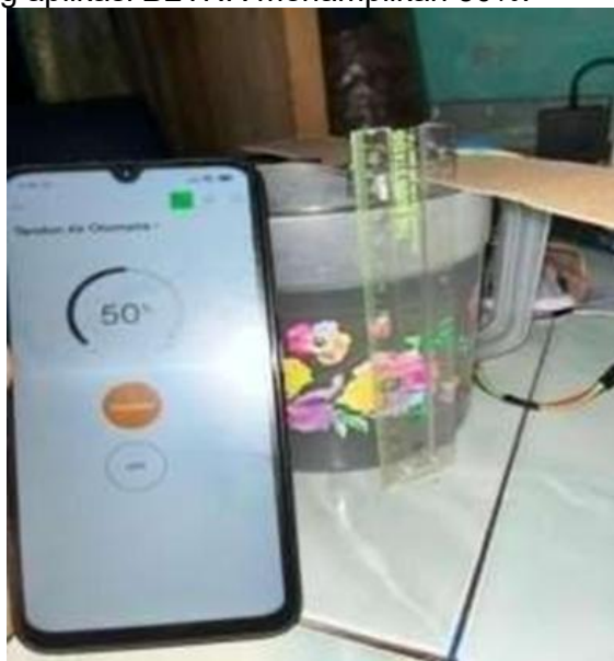
Gambar 11 Pengujian Aktual Tinggi Air
