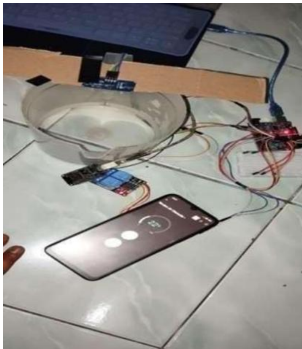
Gambar 2 Alat Tandon Air Otomatis Dengan Blynk
